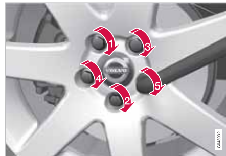
Tighten the lug nuts
