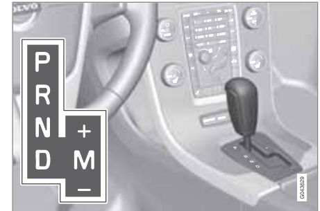
D : Automatic gear positions. M (+/-) : Manual gear positions.
