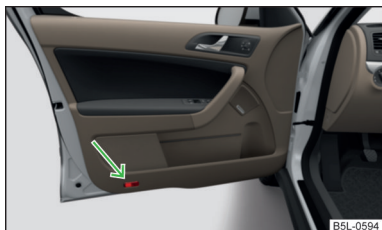
Fig. 54 Front door warning light
