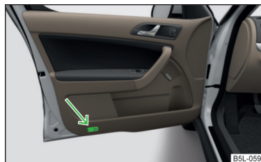
Fig. 33 Front door warning light
