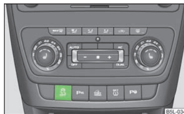
Fig. 96 ESC system: TCS button
