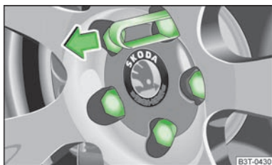
Fig. 153 Remove the cap
